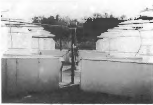
Abb.9: Teilansicht der open-top Kammern und der Gebläse- bzw. Filtereinheiten mit den auf Kabelpritschen montierten, mit Isoliermaterial umhüllten Dosier- und Meßgasleitungen sowie der Stromversorgung der Gebläse. Die Dosierleitungen für die Schadgase münden vor den Kammern in die Gebläse- bzw. Filtereinheit.
