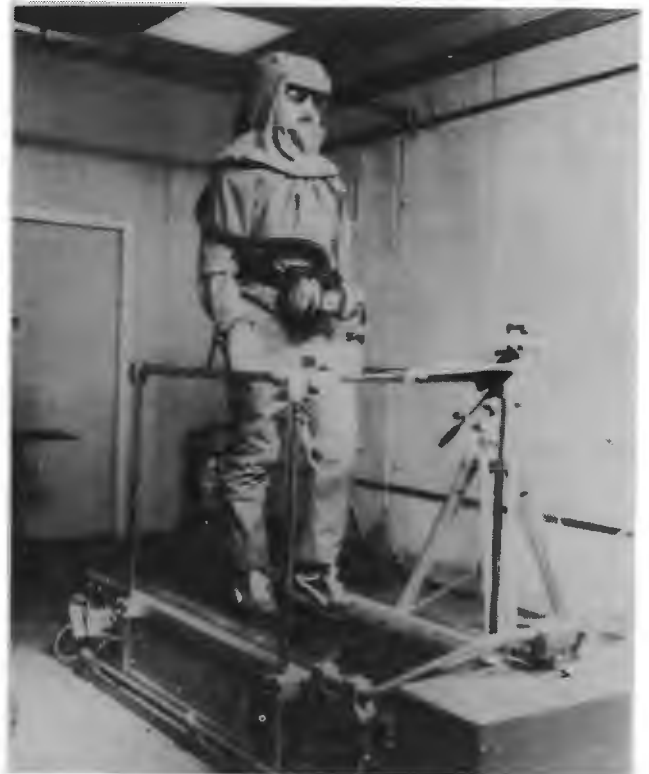
Bild 4: Proband mit belüftetem Schutzanzug auf dem Laufbandergometer.
