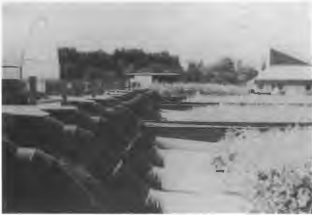
Abbildung 5: Ansicht des Feldbegasungssystems des Ontario Ministry of the Environment/Air Resources Branch/Phytotoxicology Section in Brampton/Ontario, das dem linear gradient system (s. Text) analog ist. Zu erkennen sind die Gebläseeinheiten (links), in denen die Luftfilter enthalten sind sowie die nach rechts in die Reihen der Versuchspflanzen verlaufenden, gelochten Folienschläuche, durch die konditionierte Luft (z.B. gefiltert/ungefiltert) den Beständen zugeführt wird.
