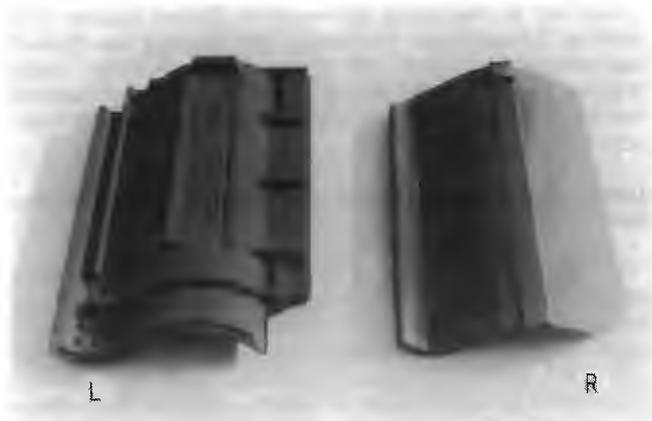
Abbildung 5: Dachziegel (Unterseite) rechts: Hohlpfanne, links: Falzpfanne
