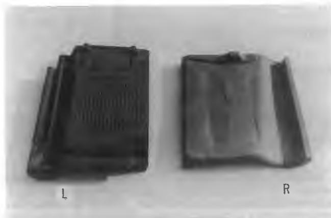
Abbildung 6: Dachziegel (Unterseite) rechts: Krempziegel, links: Flachdachpfanne
