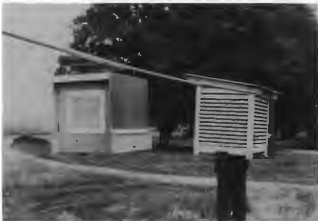
Abbildung 5: Mobile Wetterhütte im Vergleich mit einer kleinen DWD-Wetterhütte
