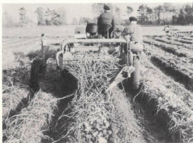
Bild 1: Ablage der Kartoffeln in einem schmalen Schwad durch einen zweireihigen Vorratsroder.
