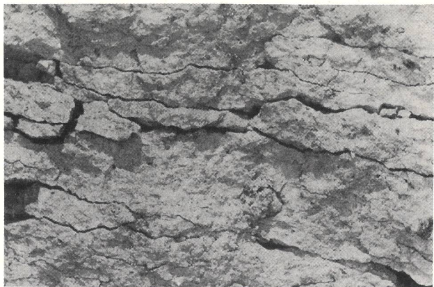
Bild 2: Plattiges Gefüge. Handstück, etwa 2 : 1 vergrößert.
