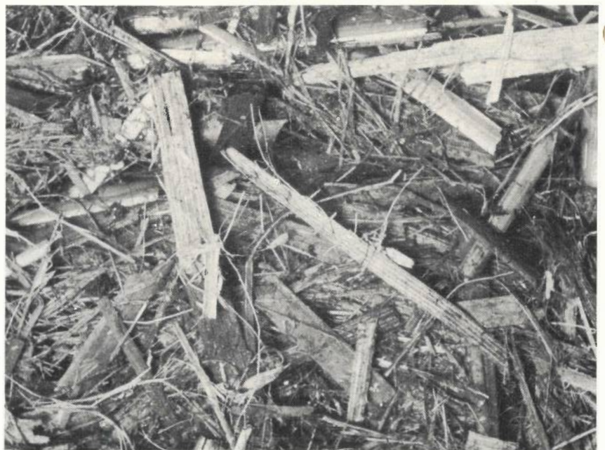
Abb. 1: Faserige Struktur des in einer Biogasanlage vergorenen Strohs.
