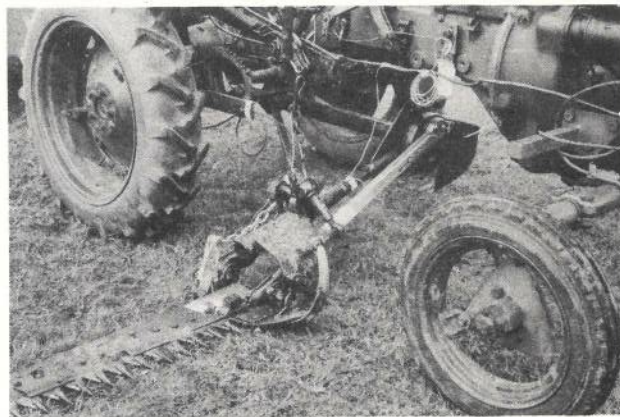
Kraft- und Beschleunigungsgeber am Mähwerk.
