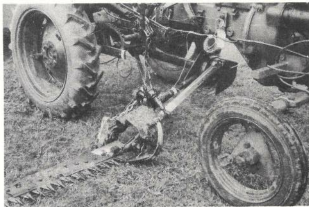
Kraft- und Beschleunigungsgeber am Mähwerk.
