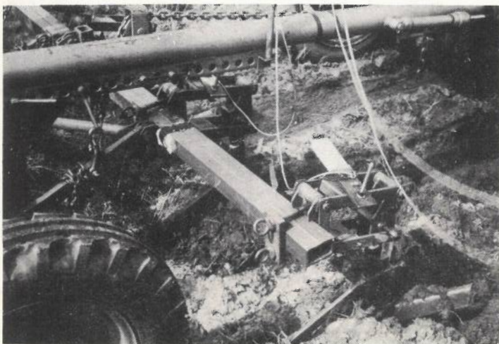
Abb. 1: Feldversuch mit einem Hackgerät zur Ermittlung der im praktischen Betrieb auftretenden Kräfte.
