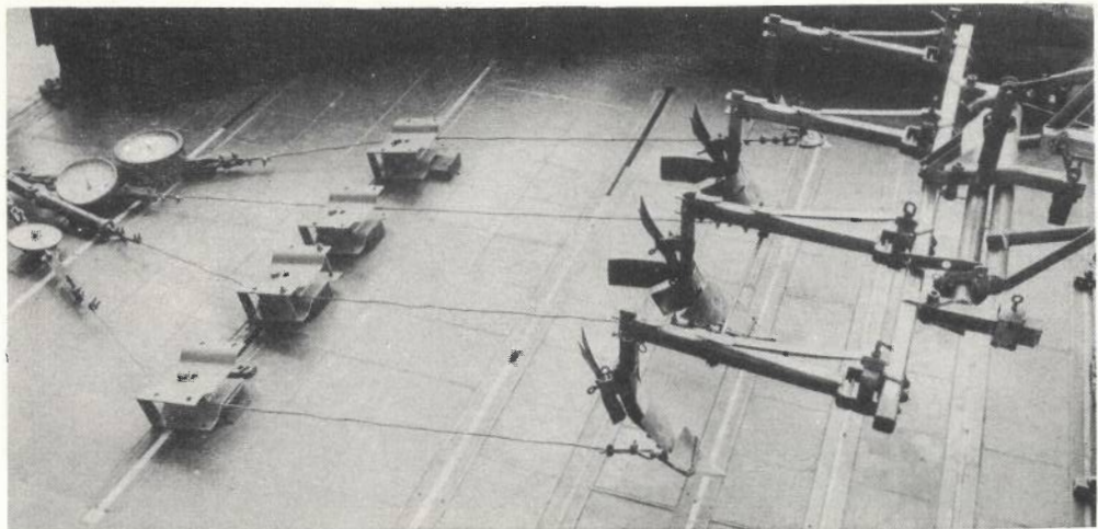
Abb. 2: Versuchsordnung und Belastungsvorrichtung bei den Festigkeitsuntersuchungen an Werkzeugschienen im Labor.
