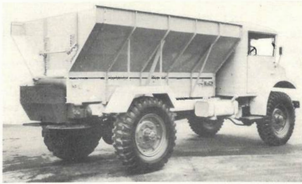
Abb. 1: Englischer Grossflächen-Kalkstreuer mit 5 t Fassungsvermögen.
