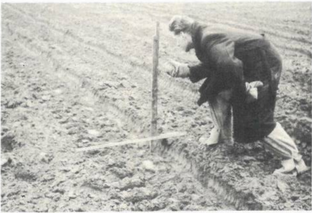
Oben und rechts: Die Messungen der Fahrwiderstände von Ackerwagen auf einem Ackerboden leicht verformbaren Zustandes werden durch Spurtiefenmessungen ergänzt.
