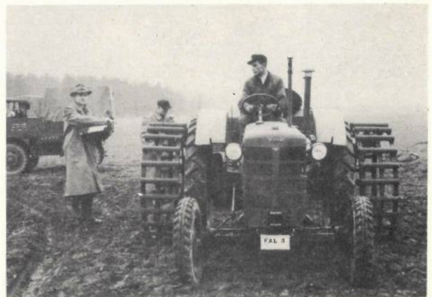
Oben und unten: Gitterräder bewähren sich nicht nur am Schlepper, sondern auch am Ackerwagen. Über ihre praktische Bedeutung werden z.Z. Untersuchungen angestellt.
