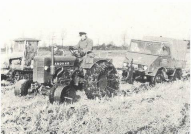
Unten: Zugkraft-Messungen auf allen Böden. Das Bild zeigt einen Schlepper mit Messwagen auf kultiviertem Hochmoor.
