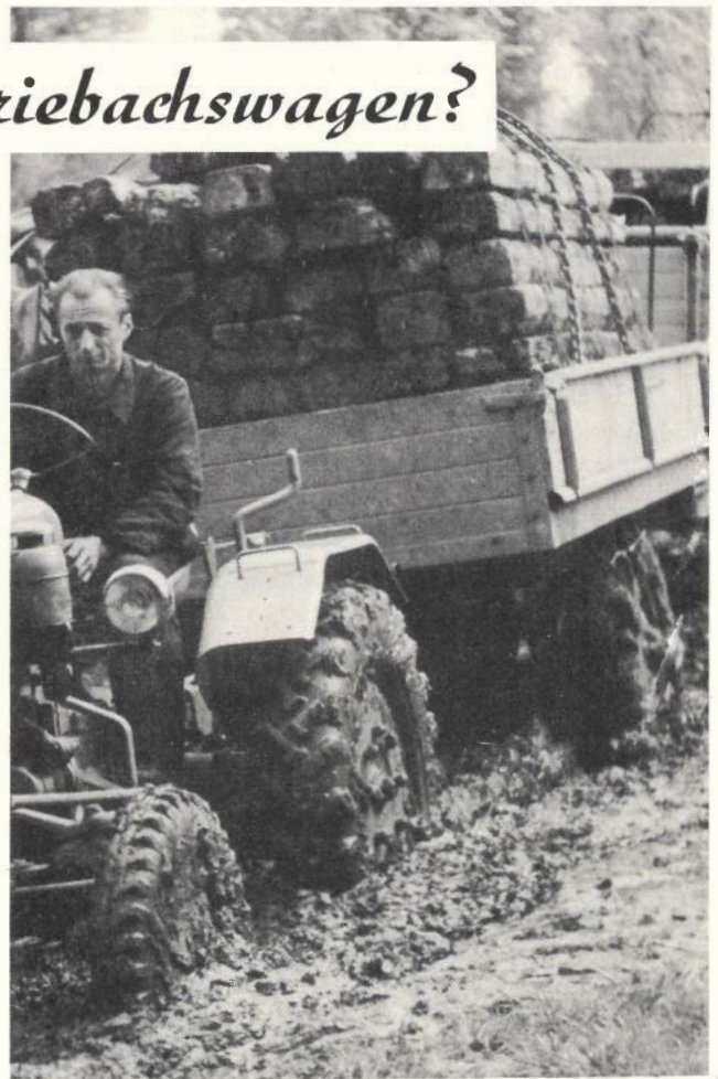
Fahrversuche mit Triebachwagen auf verschlammten Wegen. Aufnahme: Verfasser
