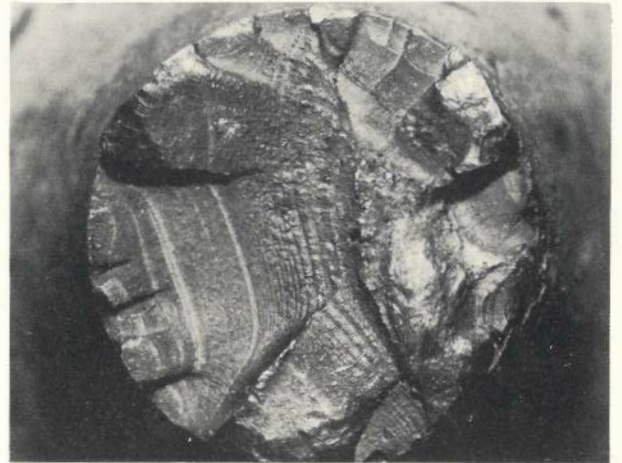
Bruchfläche (muschelrig) einer durch Dauerbeanspruchung zerstörten Welle
