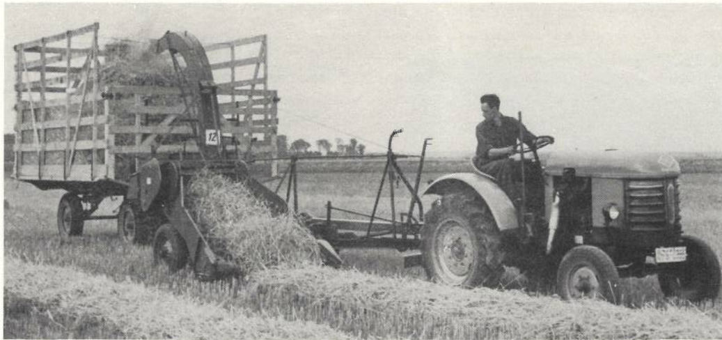
Abb. 2. In Zusammenarbeit mit der Industrie war es möglich, die Entwicklung des Feldhäckslers zu fördern, der das Einbringen von Grünfutter, Heu und Mähdrescherstroh übernimmt. Gegenüber früheren Bauarten konnte der Kraftbedarf erheblich gesenkt werden.
