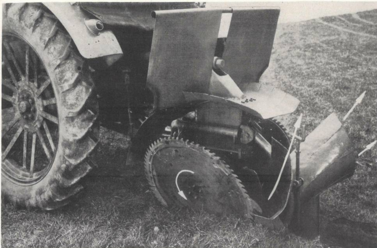
Fräskörper der Grabenfräse, bestehend aus scheibensechartigen Werkzeugen mit innen sitzenden Wurfschaufeln für den Grabenaushub (170 U/min.).
