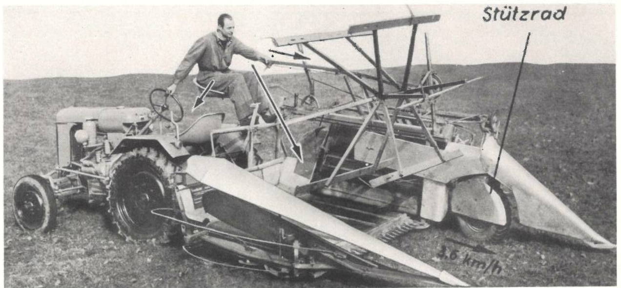
Frontbinder 1952 mit Stützrad für kleinere Vierrad-Schlepper ab 12 PS.
