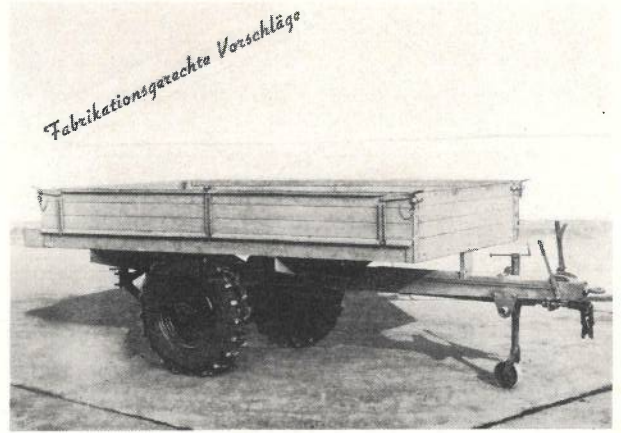
Muster eines im Institut mit Industrie-Unterstützung hergestellten Trieb-Achs-Wagens mit neuartiger gut schützbarer Zapfwellen-Übertragung und verbesserter Deichselstütze. Dia 23/52
