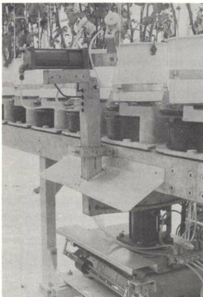
Abb. 18: Die Wägeeinrichtung mit der Waage, dem Tropfwasserabweisblech, einem der Greifzylinder und zwei der Wasserdüsen
