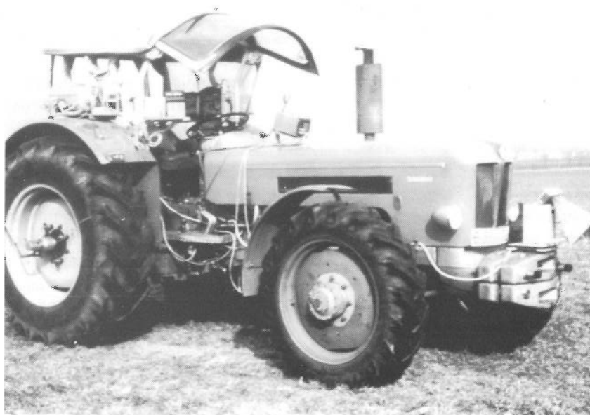
Bild 1: Versuchsschlepper mit Datenerfassungssystem und Meßwertaufnehmern
