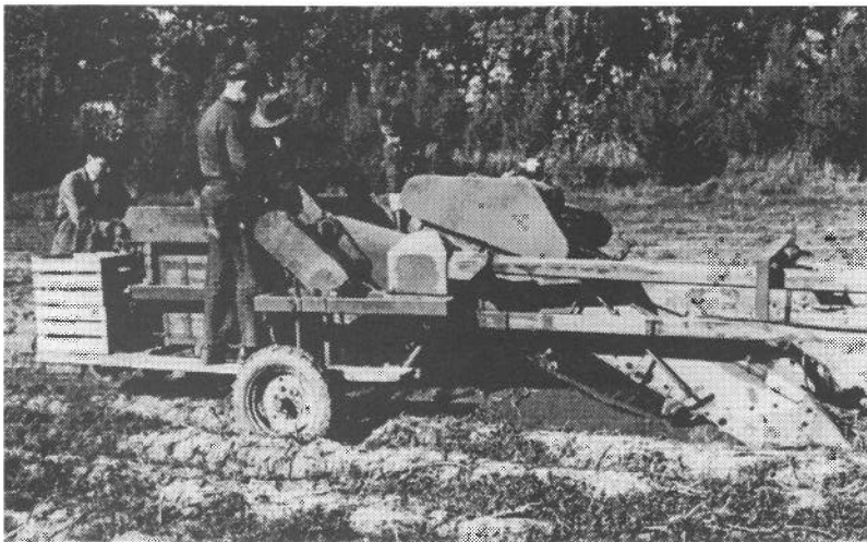
Bild 6: Kartoffelroder mit Versuchsaufbauten zur Aufnahme des Kartoffel- dammes, Absiebung der Erde sowie Trennung der Kartoffeln von Bei- mengen (Steine und Erdkluten)
