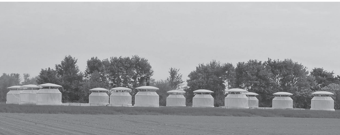
Abbildung 1: Zwölf OTCs umgeben von der Mantelsaat ( Hordeum vulgare cv. Kathleen) auf dem Versuchsfeld des Thünen-Instituts (vTI), Braunschweig. Die in den OTCs angebauten 100 Genotypen wurden in jeweils sechs der Kammern mit 390 ppm bzw. 700 ppm \text{CO}_2 versorgt.
