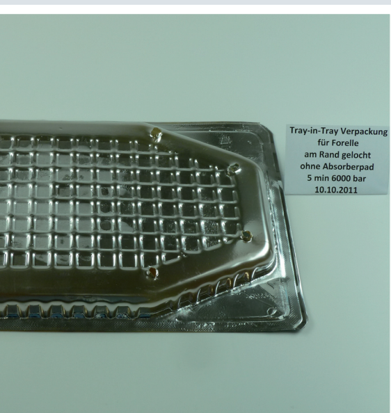
Abbildung 4: Tray-in-Tray Verpackung gelocht, 5 min 6000 bar
