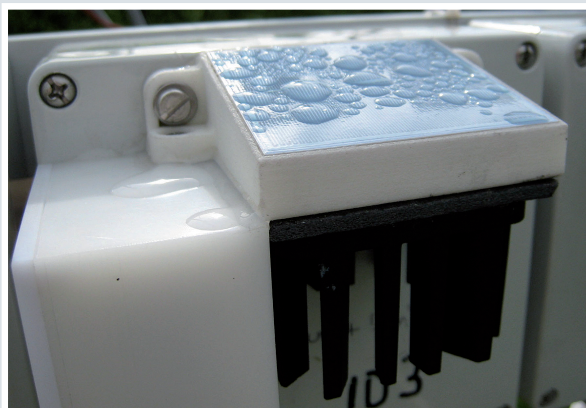
Abbildung 1: Im Projekt entwickelter Blattnässesensor
