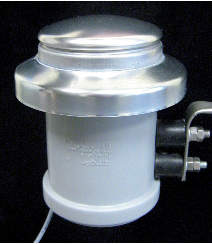
Abbildung 2: Im Projekt entwickelter Sensor für die kinetische Energie des Regens
