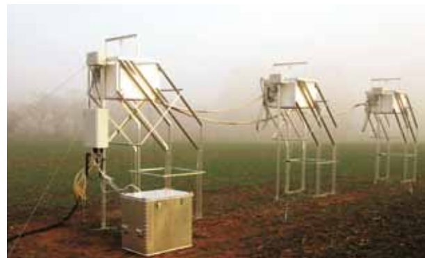
Haubenanlage zur automatisierten Erfassung der N_2O - und CH_4 -Flussraten an der Schnittstelle Boden-Atmosphäre (© Thünen-Institut für Agrarrelevante Klimaforschung)
