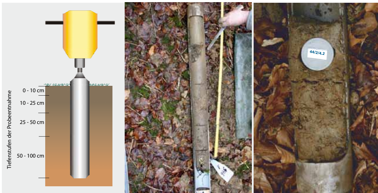
Abbildung 3 Bodenbeprobung mit der Rammkernsonde in Tiefenstufen bis 1 m Tiefe
