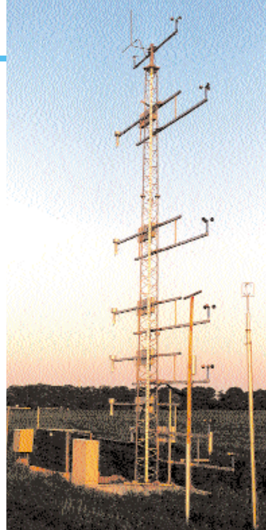
Abb. 3: Mikrometeorologischer Mast und Messgeräte-Container zur Ermittlung von Spurengasflüssen über einem Getreideschlag
