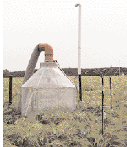
Abb. 4: Kammersystem in einem FACE-Ring zur Messung des Wasserdampf- und CO 2 -Austausches
