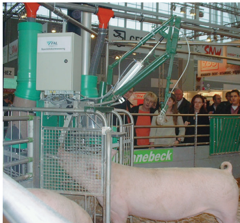
Abb. 2: Futterabrufstation mit tierindividueller Futterzuteilmöglichkeit (hier Brei-Nuckel) und einem Roboterarm mit einem Ultraschallsensor zur automatischen Rückenspeckdickenerfassung bei Schweinen (HESSE, 2003).
