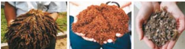
Abb. 8: Feste Abfallstoffe bei der Palmölproduktion: Leere Fruchtstände, Fruchtfasern und Schalen – Solid waste of palm oil production: Empty fruit bunches (EFB), mesocarp fibres, and shells
