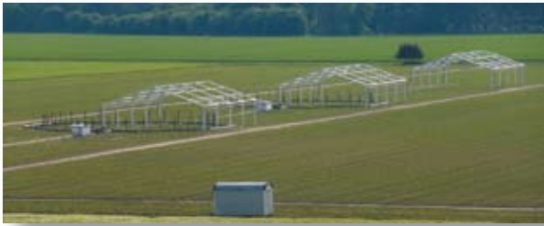
Abb. 3: Maisversuchsfeld im Juni mit FACE-Ringen zur Erhöhung der CO 2 -Konzentration und Zeltgerüsten zur Manipulation des Niederschlags – Maize field with FACE-rings for CO 2 enrichment and tent frames for control of precipitation
