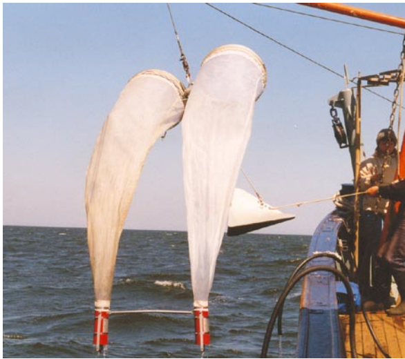
Abb. 2: Mit dem Bongo-Netz auf Heringslarven-„Jagd“ – Sampling herring larvae with a Bongo net auf der Spur.
