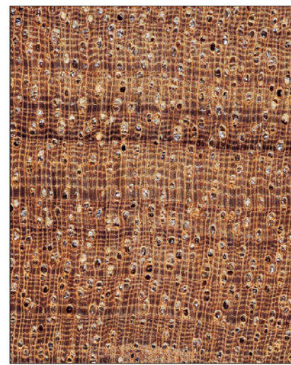
Cachimbo ( Cariniana domestica ): Querschnitt (ca. 10 x) und tangentiale Oberfläche (natürliche Größe)
