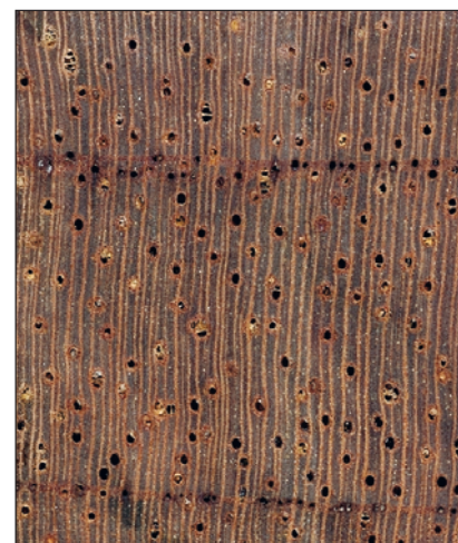
Copaiba ( Copaifera officinalis ): Querschnitt (ca. 10 x) und überwiegend tangentialer Oberfläche (natürliche Größe)
