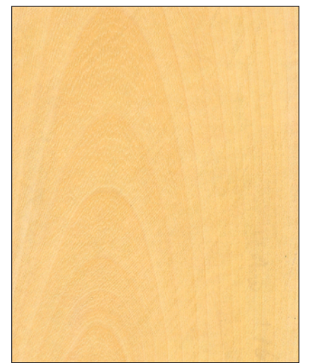
Manchinga ( Brosimum alicastrum ): Querschnitt (ca. 10 x) und tangentiale Oberfläche (natürliche Größe) Fotos: Thünen-Institut
