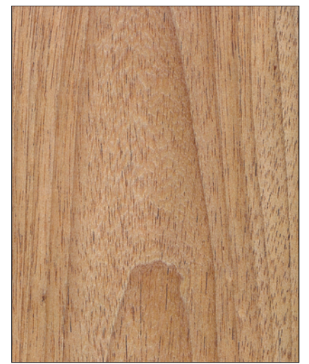
Cachimbo ( Cariniana domestica ): Querschnitt (ca. 10 x) und tangentiale Oberfläche (natürliche Größe)
