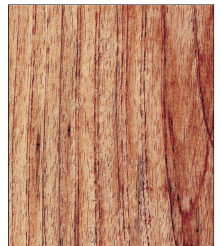
Copaiba ( Copaifera officinalis ): Querschnitt (ca. 10 x) und überwiegend tangentialer Oberfläche (natürliche Größe)
