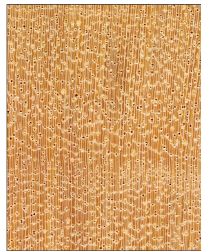
Manchinga ( Brosimum alicastrum ): Querschnitt (ca. 10 x) und tangentiale Oberfläche (natürliche Größe) Fotos: Thünen-Institut
