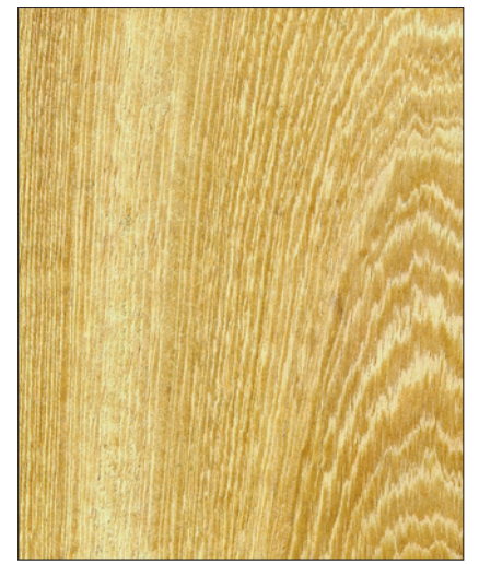
Mashonaste ( Clarisia racemosa ): Querschnitt (ca. 10 x) und tangentiale Oberfläche (natürliche Größe)
