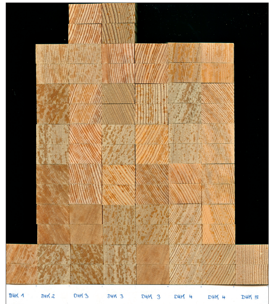
Abbildung 5 Prüfkörper (Sterilkontrollen) nach den ermittelten Dauerhaftigkeitsklassen (DHK) sortiert. Foto: VTI
