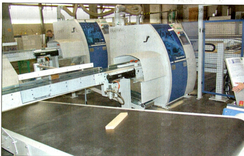
Die „Opticut“-Systemlösungen umfassen das Entstapeln, Optimieren, Kappen und Stapeln und ermöglichen bei kontinuierlichem Materialfluss höchste Ausbeute und damit Gewinn. Fotos: Ulrich Schwill
