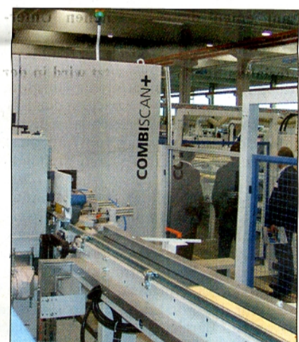
Der Scanner erfasst alle relevanten Holzdaten und versorgt bei voller Produktionsgeschwindigkeit bis zu vier „Opticut“ mit den Optimierungsdaten für den Zuschnitt.
