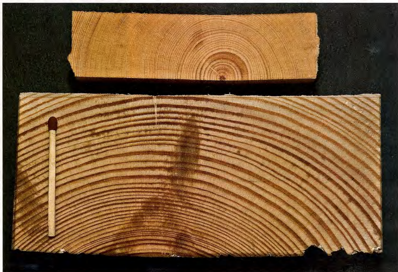
Abbildung 1 Ein Vergleich der Querschnitte einer mindestens 115-jährigen Polarkiefer (oben) mit einer einheimischen Kiefer (unten), beide Pinus sylvestris L., verdeutlicht den extrem feinen Jahrringaufbau der Polarkiefer. Fotos: Hansen
