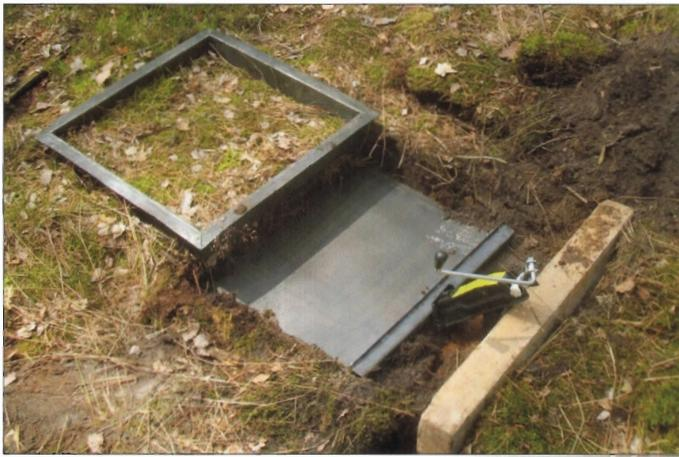
Abb. 2: Entnahme eines Probe-Monolithen für Brandversuche
