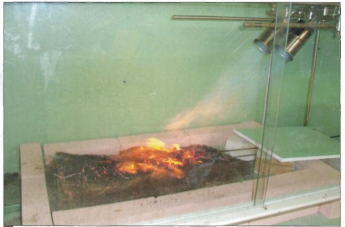
Abb. 3: Abbrennen der Probe, rechts die Temperaturfühler in drei Tiefen
