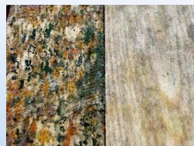
Abb. 2: Struktur des Pilzbefalles auf hitzebehandeltem (links) und nicht-hitzebehandeltem (rechts) Kiefernspiltholz nach zweiwöchiger Lagerung unter Folie in sehr feuchtem Klima.
