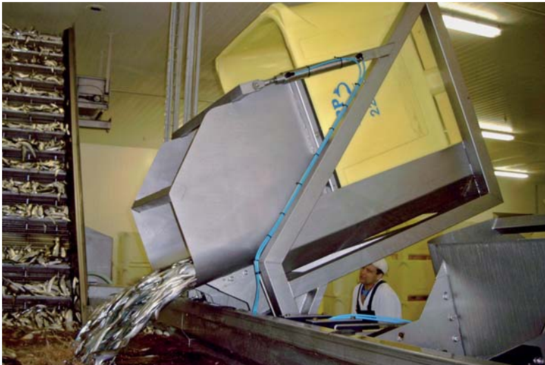
Abb. 7: Entleeren der gewogenen Tubs in das Elevatorbecken
