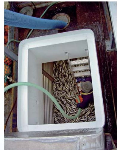
Abb. 2: Saugschlauch und Wasserrückführung im Fischraum des Fangschiffes
