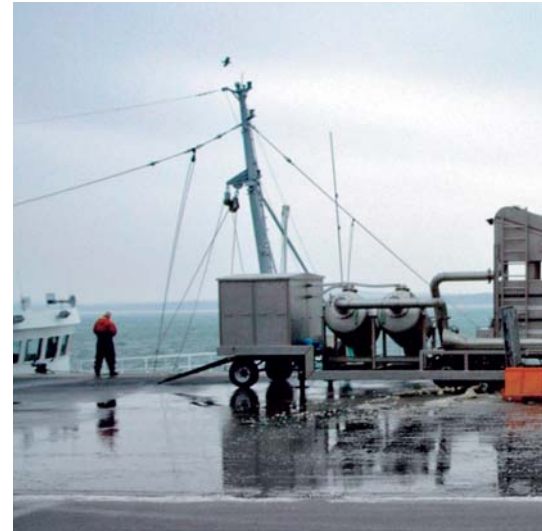
Abb. 9: Druck-Vakuumanlage mit transportablem Auffang-
