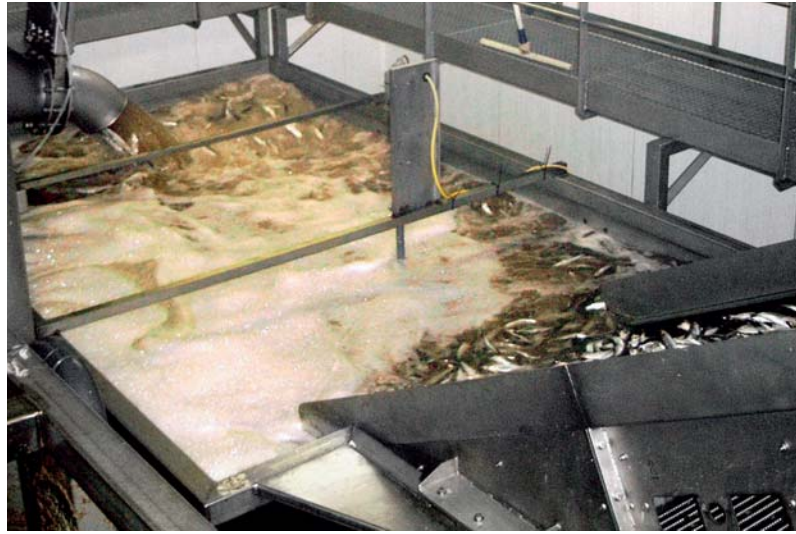
Abb. 10: Auffangbecken mit Elevator
