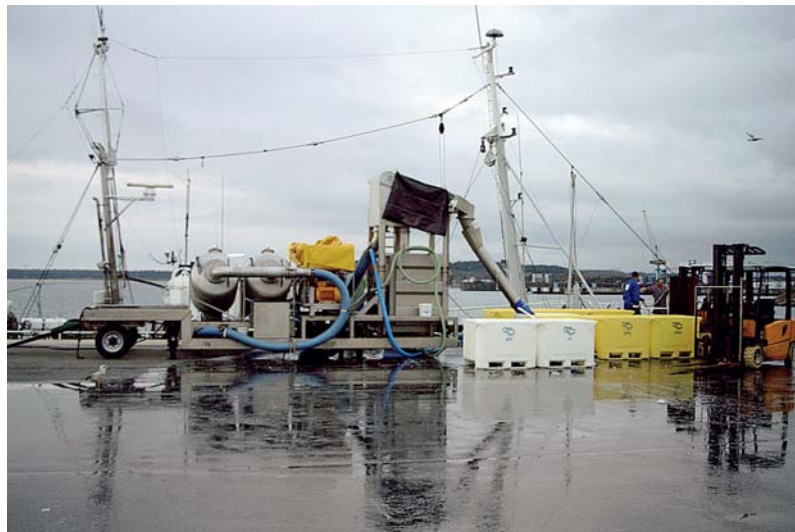
Abb. 3: Doppelkammer-Anlage bei der Befüllung von Tubs (Großraumbehälter)
