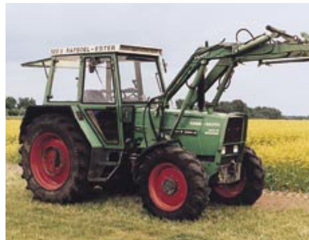
Biodiesel-Praxistest: Der Versuchs-Schlepper des Institutes für Biosystemtechnik wird seit 1982 mit Biodiesel betrieben
