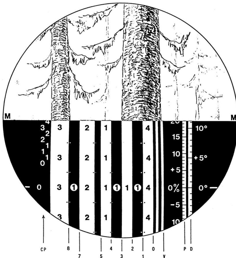
Abbildung 8: Teilansicht der Skala des Spiegelrelaskop (Metrisch CP); Quelle: BMELV 2011<sup>1</sup>
