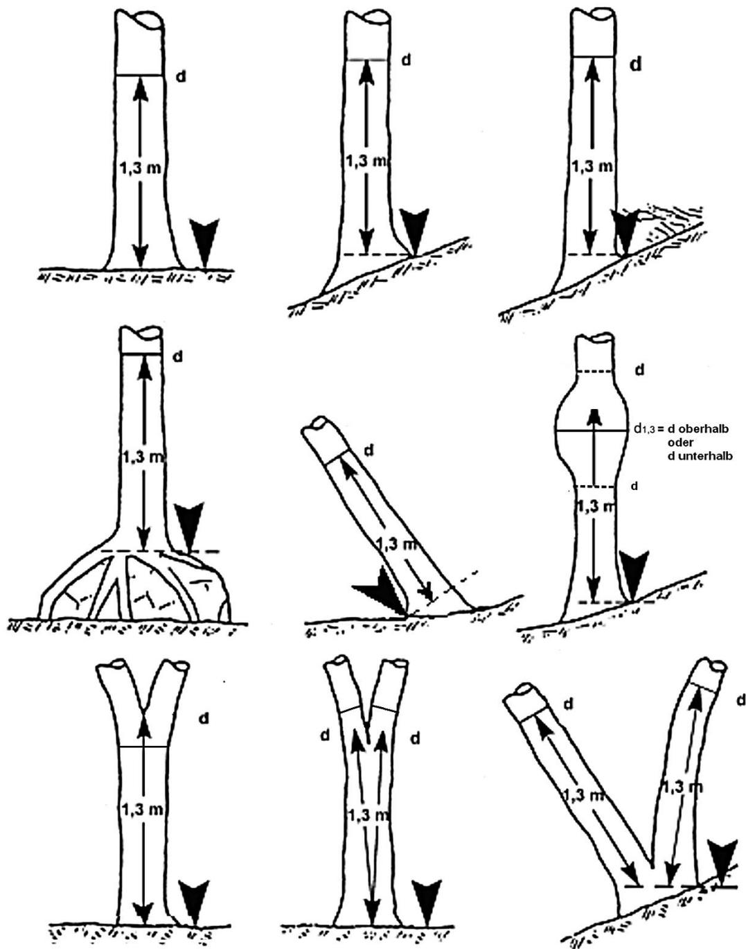
Abbildung 5: Messposition des Brusthöhendurchmessers (BHD);
