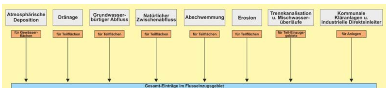
Abbildung 32: Schematische Darstellung der Modellierung des mehrjährigen mittleren Phosphoreintrags mit MEPhos
