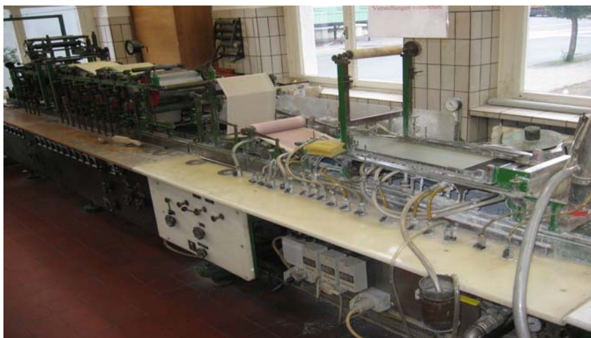
Abb. 23. Versuchspapiermaschine im Technikum der Technikum der Papierfabrik Ahlstrom Osnabrück GmbH
