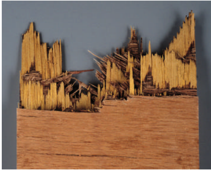
Bild 2: Bruchbild eines Zug-Prüfkörpers nach EN 789. Unterschiedliche Holzarten innerhalb des Sperrholzes erkennbar.
