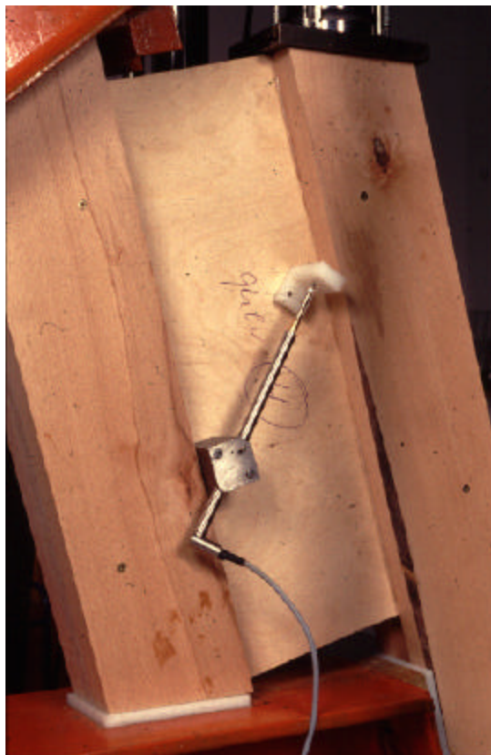
Bild 1: Prüfkörper zur Bestimmung des Schubmoduls quer zur Plattenebene aus Birken-Furniersperrholz in der Schervorrichtung nach EN 789. Joche aus Buchenholz zur Krafteinleitung. Induktiver Aufnehmer zur Verformungsmessung.
