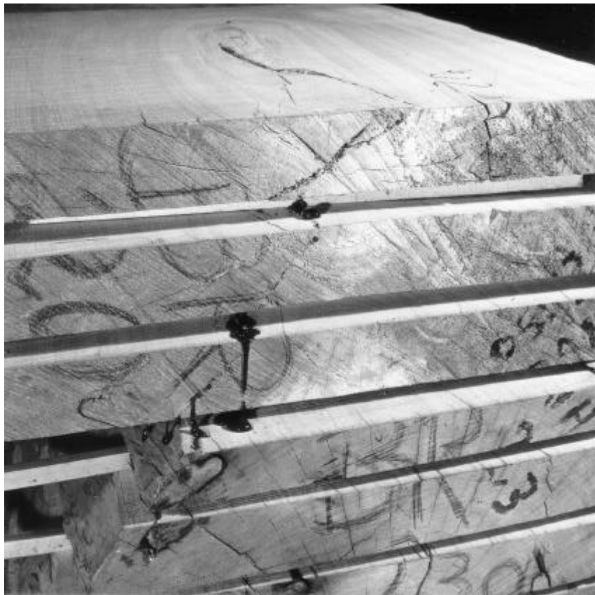
Bild 2: Beispiel für Harzausfluß bei der Blockware nach dem Trocknen
