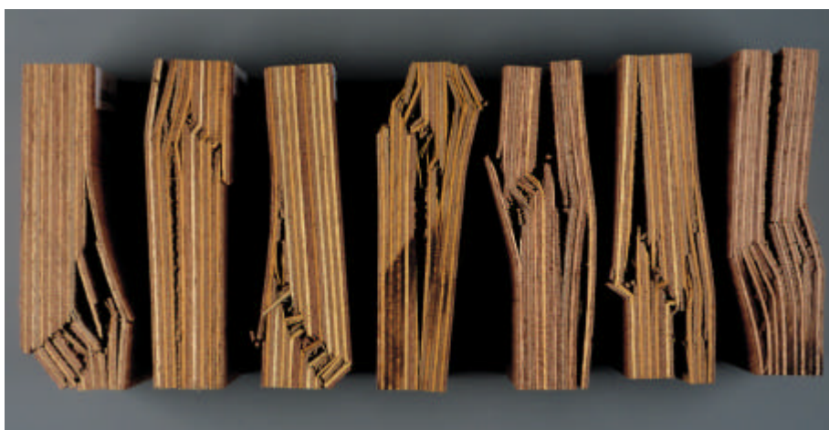
Bild 3: Druck-Prüfkörper nach EN 789. Stauchbrüche und Spaltbrüche erkennbar.
