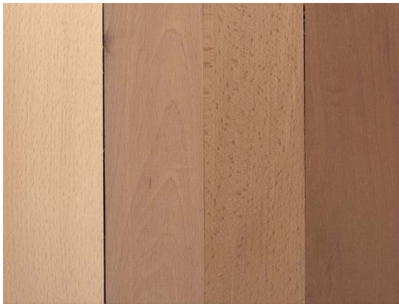
Bild 17 Von links nach rechts: ungedämpfte Buche, gedämpfte Buche bei 120, 130 und 140° mit 4 Stunden Dämpfzeit
