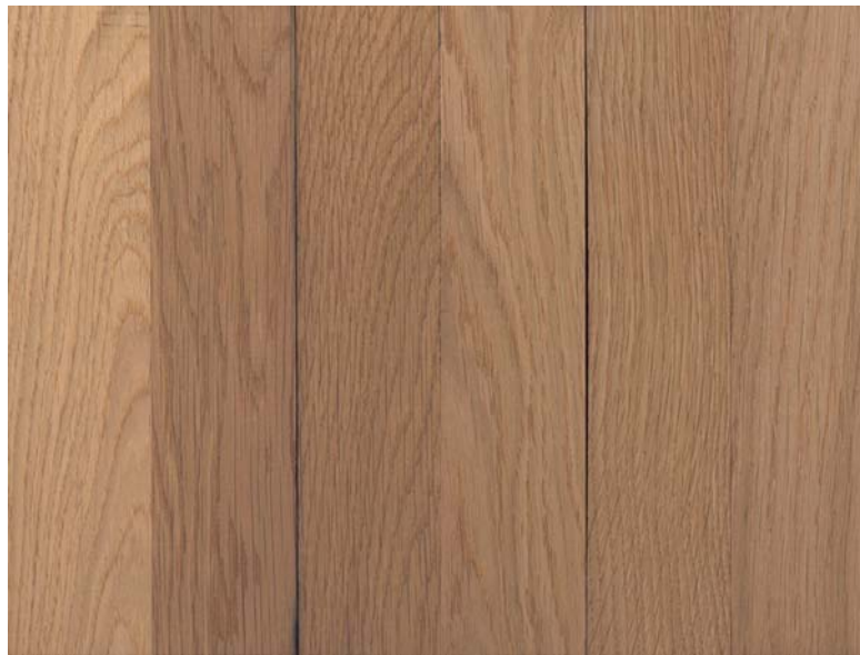
Bild 18 Von links nach rechts: ungedämpfte Eiche, Eiche gedämpft mit 95° 48 und 72 Stunden, 110° mit 4 und 10 Stunden, 120° mit 2 Stunden
