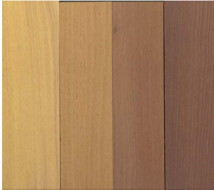
Bild 9 Von links nach rechts: ungedämpfte Robinie, druckgedämpfte Robinie mit 2, 4 und 10 h Haltezeit bei jeweils 120 °C.
