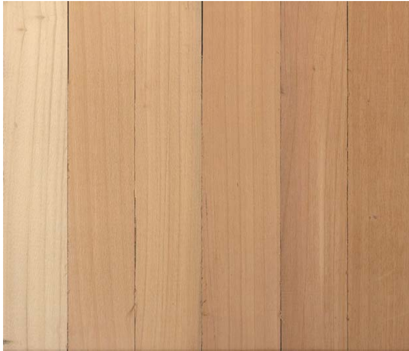
Bild 16 Von links nach rechts: Farbe der ungedämpften Pappel, gedämpft mit 95° 48h, 120° mit 4 und 10h, 130 und 140° mit 4 h
