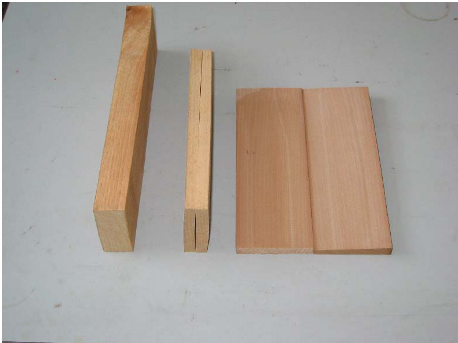
Bild 24 Versuchsanordnung Farbmessung bei vergrauter Buche
