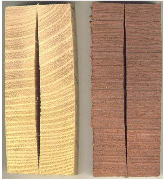
Bild 12 Verringerung der Verschalung durch Druckdämpfen bei technisch vorgetrocknetem Robinienholz; Anwendung der Mittenschnitt-Methode, links vor, rechts nach dem Druckdämpfversuch, Versuch (140 °C 2 h)
