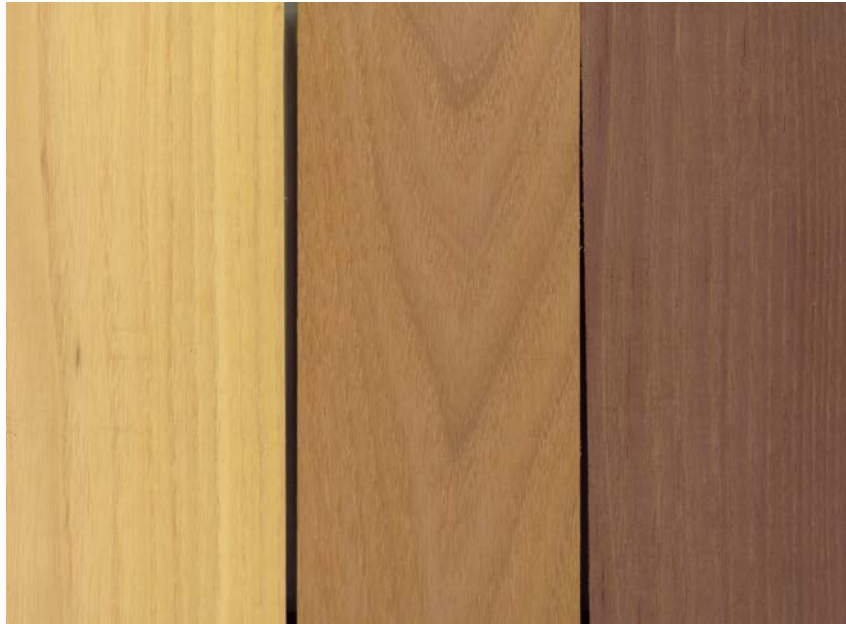
Bild 7 Erreichbare Farbpalette bei Robinienholz (von links nach rechts: ungedämpft, 120°C/4h, 140°C/2h)
