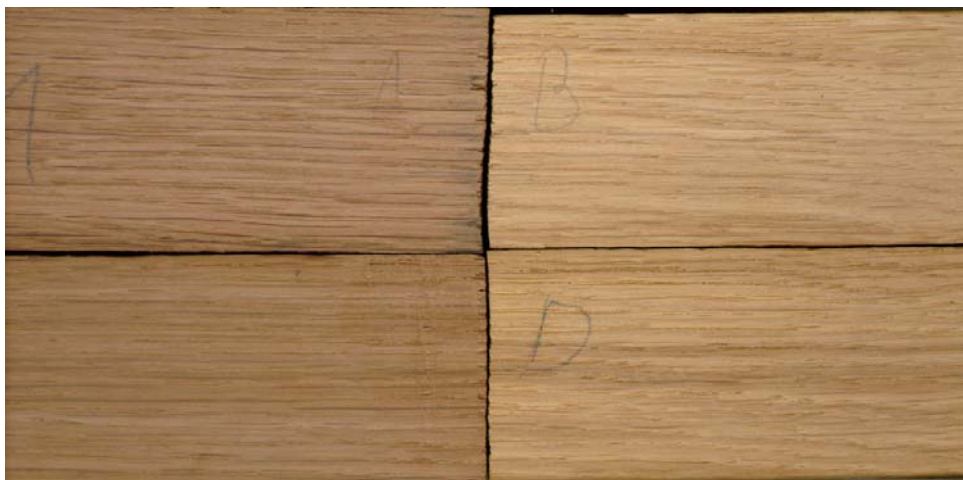
Bild 19 Farbangleich bei fleckiger Eiche. Links ungedämpft, Rechts nach dem Dämpfen
