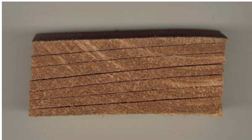
Bild 14 Durchfärbung über den Querschnitt bei Pappel gedämpft mit 140°C und 2 Stunden Dämpfzeit
