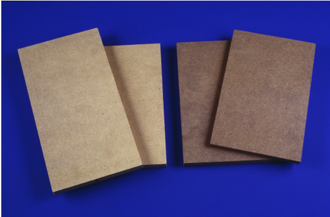
Abbildung 8: MDF-Platten aus Fichte und Nipa.
