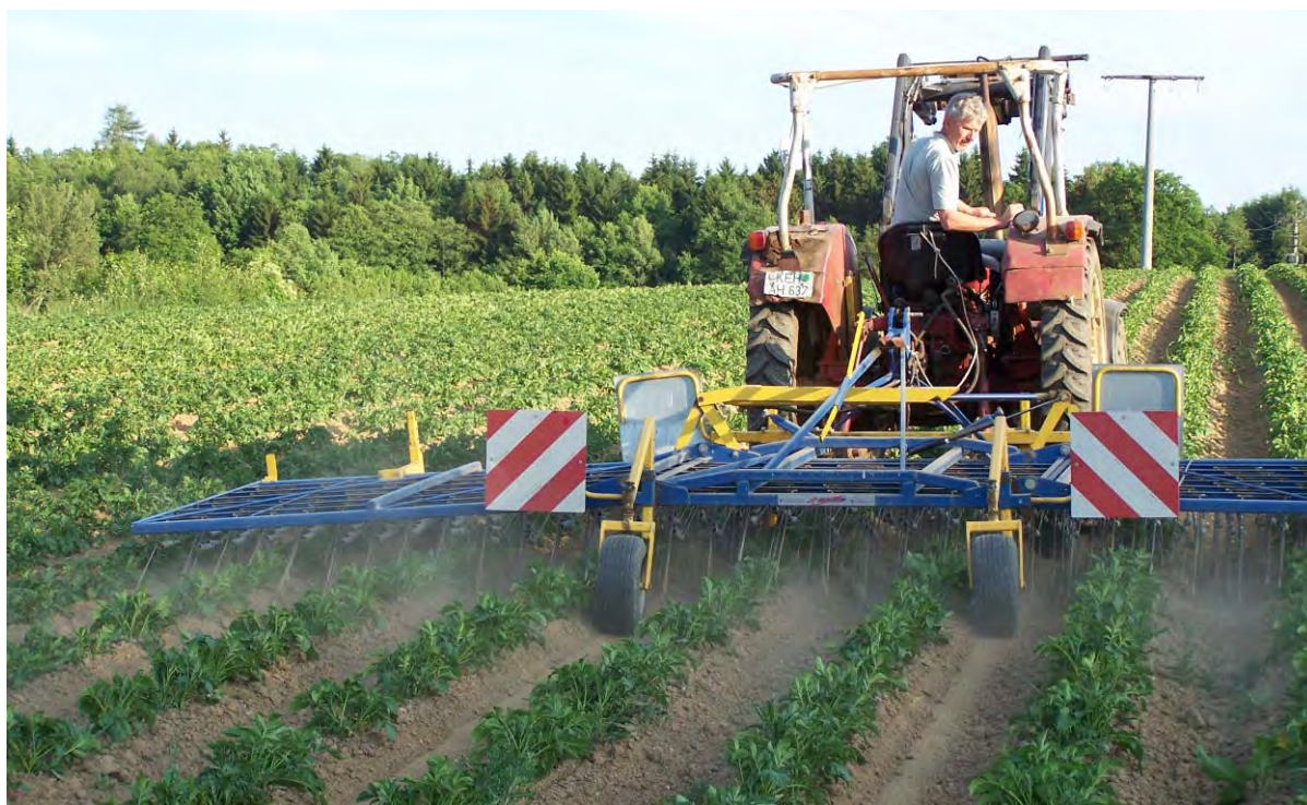
Abbildung 8: Einsatz des Trefflerstriegels in Kartoffeln
