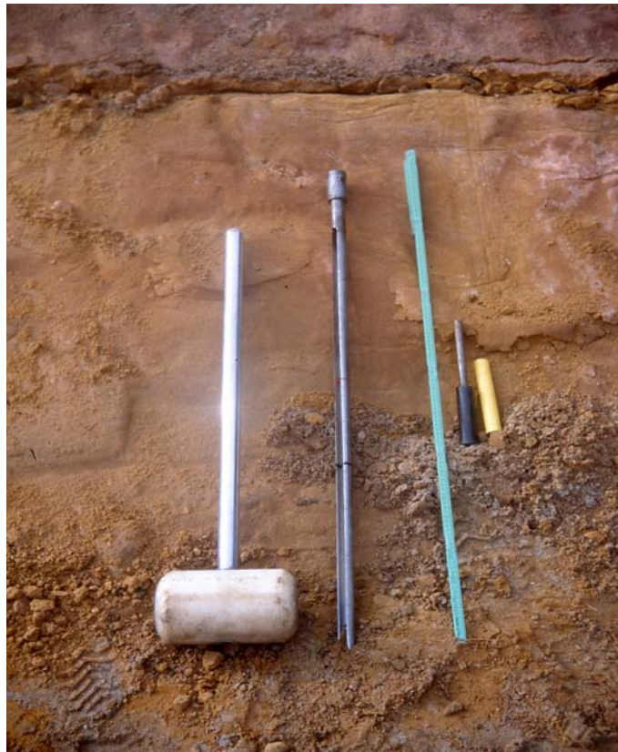
Abb. 27: Ausrüstung für Probenentnahme Probe drill equipment
