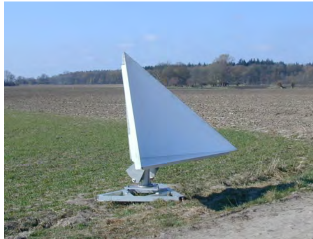
Abb. 3-14: Cornerreflektor für die radiometrische Kalibrierung und die Geokodierung der Radardaten.
