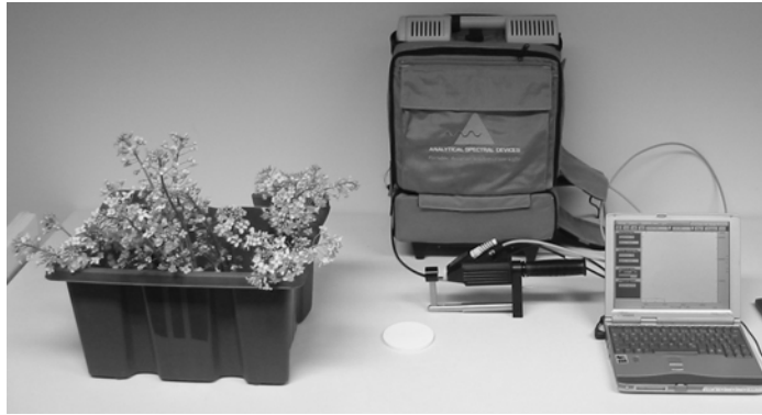
Abb. 5: Messaufbau zur spektralen Vermessung gelber und weißer Rapsblüten mit einem ASD-Fieldspec® Pro JR Spektrometer mit plant probe Messkopf
