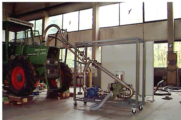
Abbildung 5.11: Abgasverdünnungstunnel am Schlepper-Prüfstand (ohne Isolierung und Messgeräte)
