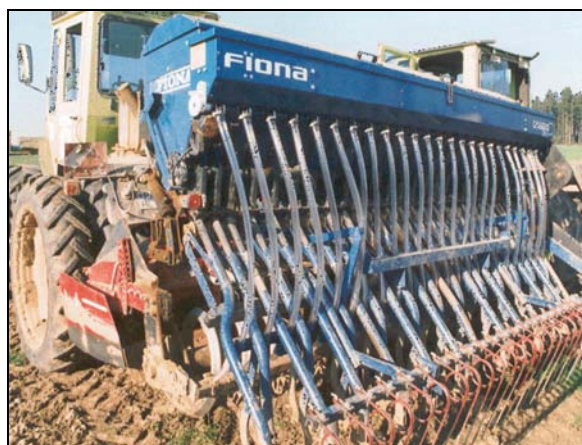
Abb. 5: Standard-Drillmaschine (3m, 24 Reihen) mit Nachsaatkästen und 24 flexiblen Auslaufschläuchen, Pfaffenhofen 2003
