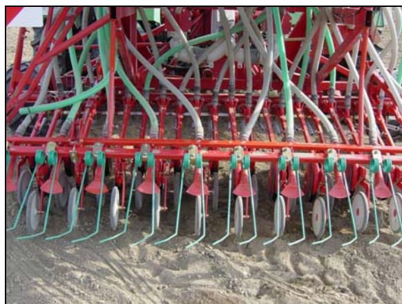
Abb. 11: Umsteckmöglichkeiten von Säschräuben an verschiedene Säaggregate einer Parzellendrillmaschine, Trenthorst 2003
