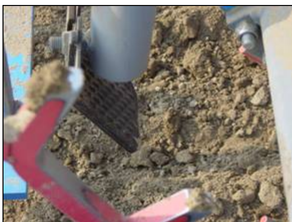
Abb. 7: Prallteller unter dem Auslaufrohr eines Nachsaatkastens für eine breitere Verteilung der Saat, Trenthorst 2003
