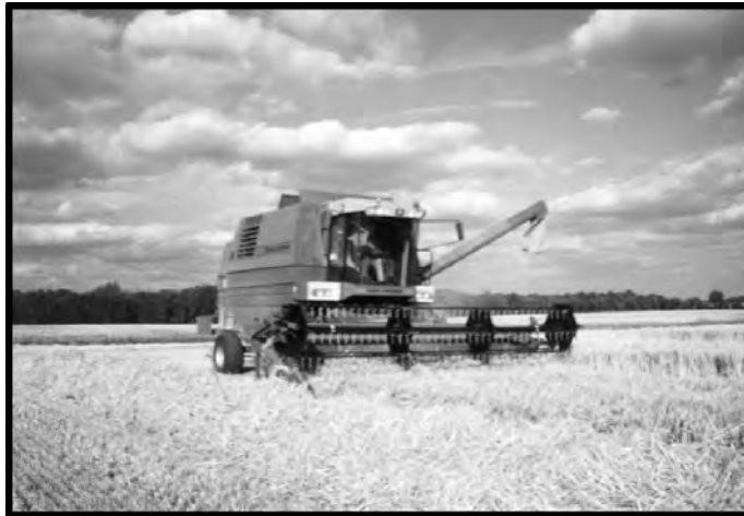
Abb. 2-11: Massey Ferguson Mähdrescher mit Flowcontrol Ertragssensor und DGPS.
