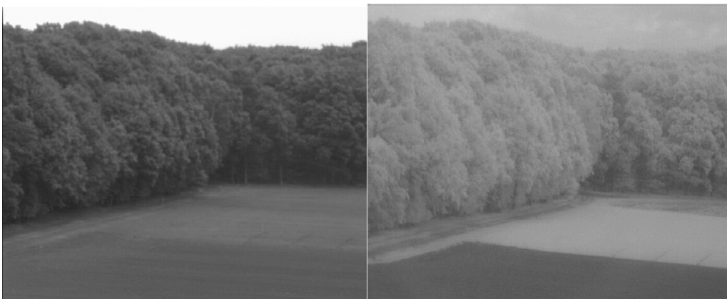
Abb. 2-10: Der „Wood-Effekt“ im Infrarotbild.
