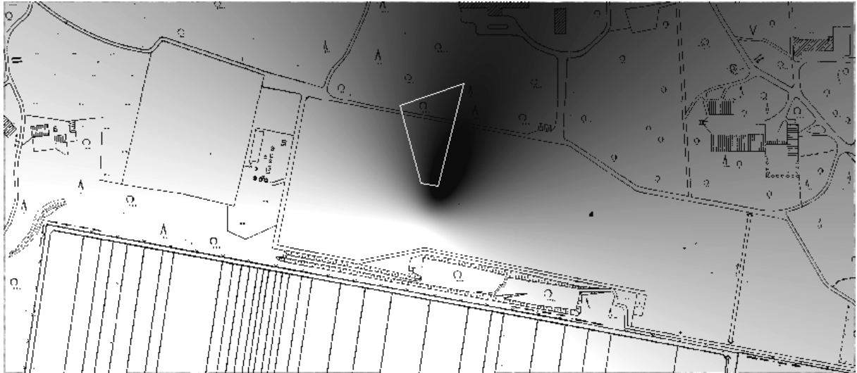
Abb. 4-8: Das richtungsabhängige Reflexionsverhalten, dargestellt anhand des Scatteringwinkels für die Aufnahmesituation vom 27.05.2003, 13:05 Uhr. Helle Grauwerte bezeichnen eine geringe, dunkle eine hohe richtungsabhängige Reflexion.
