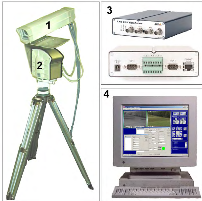
Abb. 3-4: Komponenten für ein bodennahes Fernerkundungssystem.
