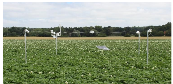
Abbildung 1: Infrarot-Temperatur Sensoren und Wettermesstechnik auf einem Kartoffelfeld im Jahr 2018.
